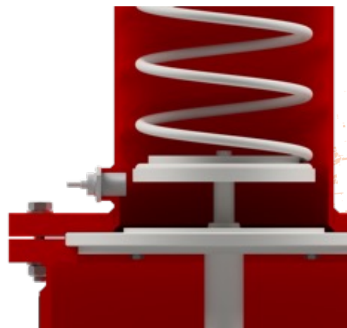
Fig. 4 : Schéma en coupe du clapet à ressort d'une soupape de surpression ou de dépression en ligne avec détecteur d'ouverture.
