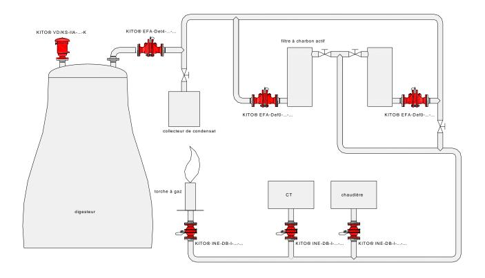
Arrête-flamme en ligne bidirectionnel, anti-détonation et résistant au brûlage de courte durée KITO® EFA-Det4-IIA-.../...-1,2 (G 22 N)
