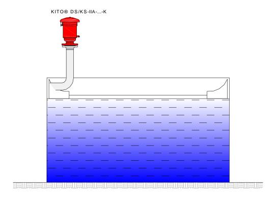
Ventilation de l'anneau : Soupape de surpression anti-déflagration et résistant au brûlage continu KITO® DS/KS-IIA-...-K (C 7 N) alternative soupape de surpression KITO® DS/o-...(C 8.1 N), n'est pas antidéflagrant
