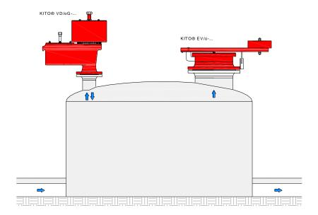
: Soupape de surpression/dépression KITO® VD/oG-... (E 21 N) Ventilation Ventilation de secours : Soupape de surpression KITO® EV/o-... (C 10.1.N) (cas d'incendie)
