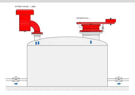
Ventilation : Soupape de surpression/dépression anti- déflagration KITO® VD/AE-...-IIB3 (E 20 N)
