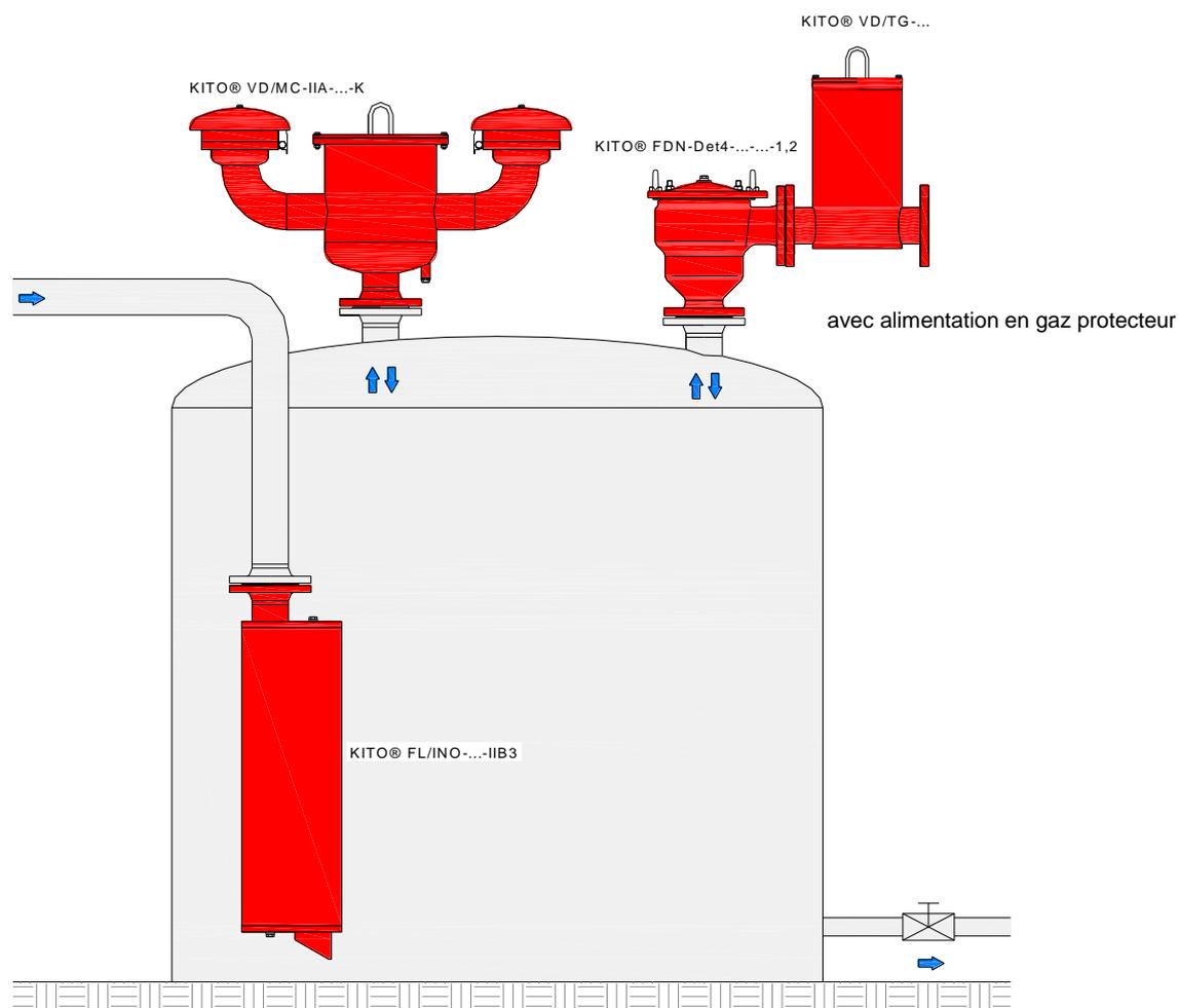
conduite de remplissage : Joint hydraulique bout de ligne anti-détonation, unidirectionnel
