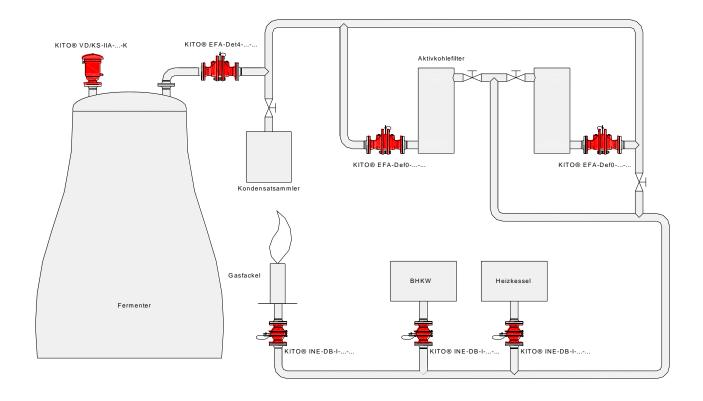
Detonationsrohrsicherung bi-direktional, kurzzeitbrandsicher KITO® EFA-Det4-IIA-.../...-1,2 (G 22 N)
