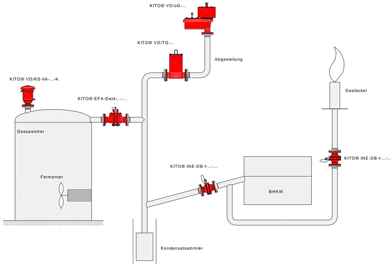
Detonationsrohrsicherung bi-direktional, kurzzeitbrandsicher KITO® EFA-Det4-IIA-.../...-1,2 (G 22 N)
