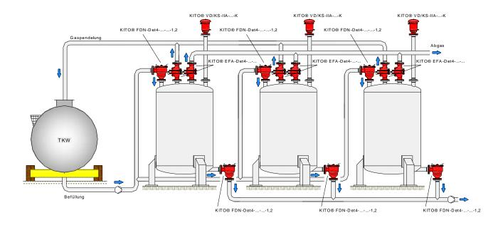
Saug- und Füllleitung : Detonationsrohrsicherung uni-direktional, kurzzeitbrandsicher
