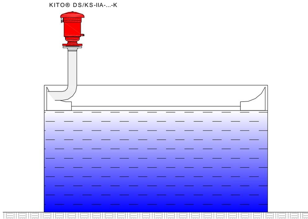
Ringraumlüftung : Deflagrations- und dauerbrandsicheres Überdruckventil KITO® DS/KS-IIA-...-K (C 7 N)
