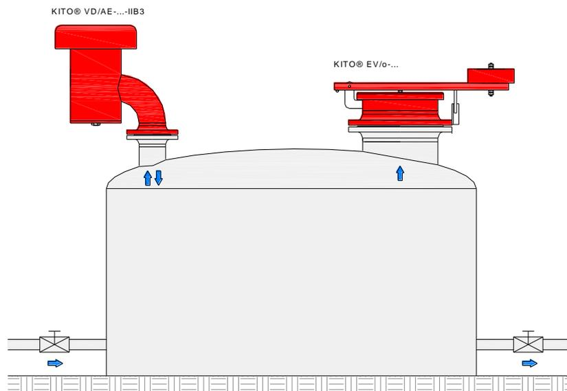
Be- und Entlüftung : Deflagrationssicheres Über- und Unterdruckventil KITO® VD/AE-...-IIB3 (E 20 N)
