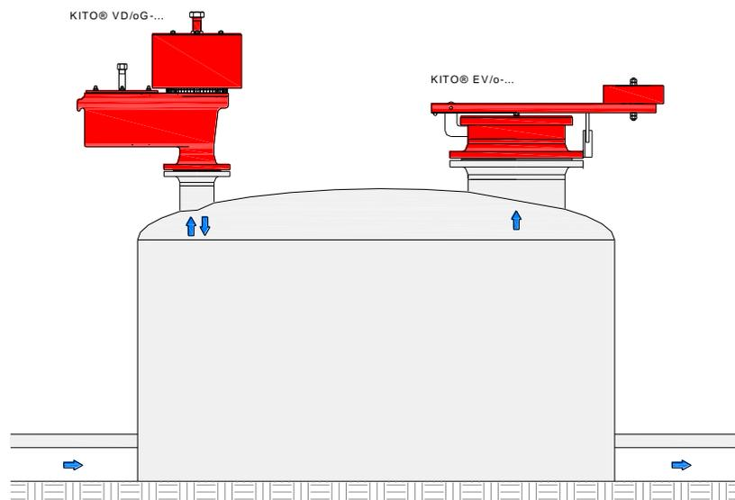
Be- und Entlüftung : Über- und Unterdruckventil KITO® VD/oG-... (E 21 N)
